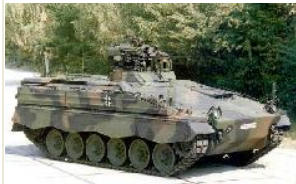
Marder 1 - Veículo Blindado de Combate da Infantaria. - Armas: 20mm+7,62mm - Algumas versões com Milan na torre
