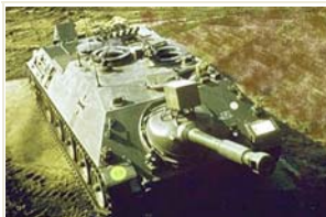
Jagdpanzer Kanone - Armas: 90mm + 7,62mm - "Tank Destroyer" - Ângulo de tiro de 15° para cada lado.
