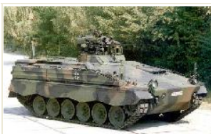
Marder 1 - Veículo Blindado de Combate da Infantaria. - Armas: 20mm+7,62mm - Algumas versões com Milan na torre
